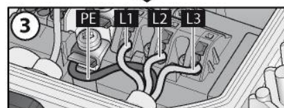
Fig. 3: Anslutning av ledningarna till plintarna
